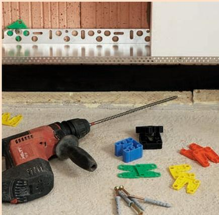
Sockelabschlussprofil nach Dämmstoffdicke bestimmen, waage- und fluchtgerecht ausrichten, nicht press stoßen und mit Nageldübel befestigen. Zum Ausrichten Ausgleichsstücke verwenden.
